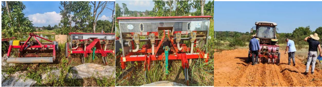
图 3 花生轻简型起垄精量播种机和挖掘收获机在吉安农高区坡耕地的现场作业
